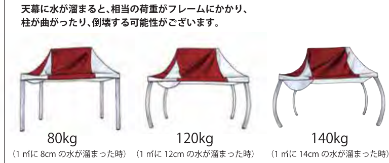
80kg (1㎡に8cmの水が溜まった時) 120kg (1㎡に12cmの水が溜まった時) 140kg (1㎡に14cmの水が溜まった時)
